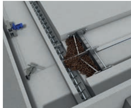
El rascador transporta las heces para la retirada transversal
