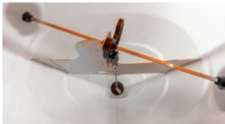
El agitador evita el apelmazamiento del pienso
