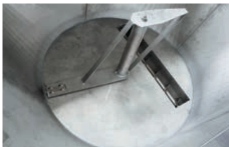
Fondo del depósito con cuchillas en Z y rosca de extracción
