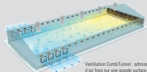
Ventilation CombiTunnel : admission d'air frais sur une grande surface par le volet d'aération MultiVent 17 M en mode tunnel
