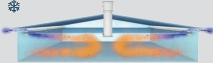
Dans le cas de températures extérieures basses, l'air frais est guidé le long du plafond du bâtiment. L'air y est ainsi réchauffé avant d'atteindre la zone des animaux.
