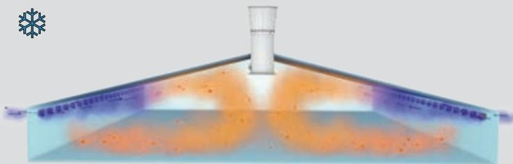
Dans le cas de températures extérieures basses, l'air frais est guidé le long du plafond du bâtiment. L'air y est ainsi réchauffé avant d'atteindre lentement la zone des animaux.
