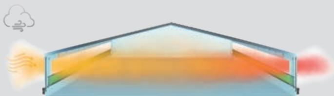
Ventilation naturelle dans les bâtiments jusqu'à une largeur maximale de 15 m
