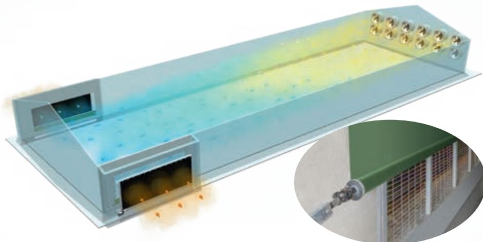
Rideau roulant comme fermeture sûre de tunnel en combinaison avec le système PadCooling RainMaker
