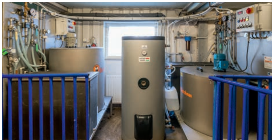
Kuchnia paszowa systemu CulinaCup z dwoma zbiornikami mieszającymi
