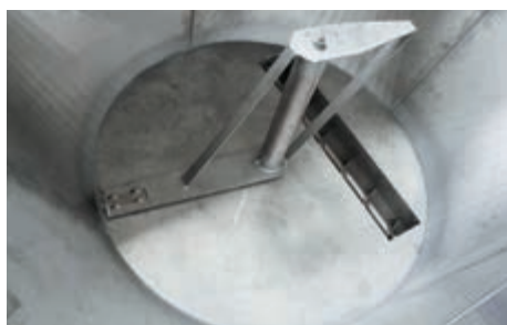
Дно емкости с Z-образной взмешивающей крестовиной и подающим шнеком
