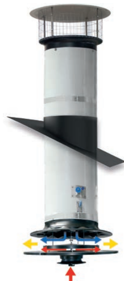
F.A.C. 2 з вузлом для підмішування теплого повітря з метою рівномірного розподілу свіжого повітря
