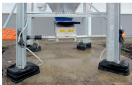
Захисне покриття для бункерних опор забезпечує надійне зважування в екстремальних погодних умовах
