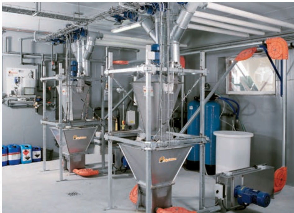
DryExact pro в кормокухні: дві установки, по одному контуру годівлі на кожну
