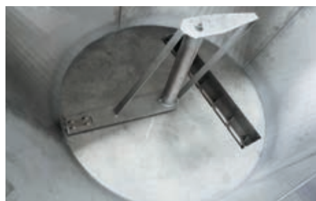
Дно бункера з Z-подібним відвалом і вивантажувальним шнеком
