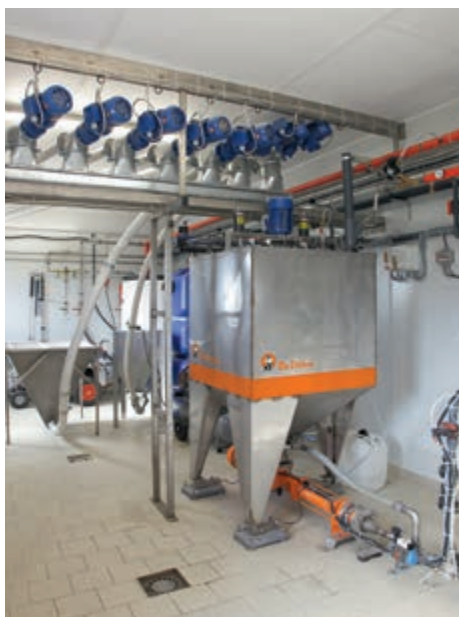
1-бакова система (без залишків) зі стисненим повітрям
