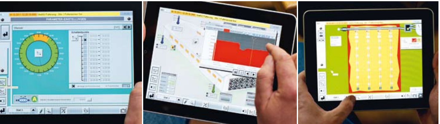
>>Links: Überblick über den aktuellen Wasserverbrauch. Mitte: Auch der Temperaturverlauf im Stall kann über das iPad eingestellt und analysiert werden. Rechts: Das System zeigt an, dass die Fütterung in Stall 2 gerade läuft.
