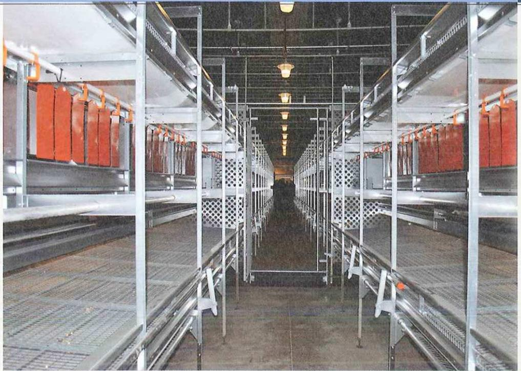
▲ Salle équipée de nids intégrés en PVC, tôle galvanisée, à fond relevable.
