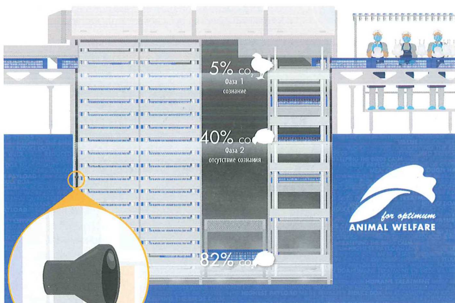
Запатентованная видеосистема позволяет следить за движением ящика в газовом модуле
