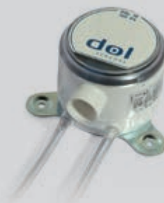
Avec DOL 18, nous disposons d'un capteur de pression négative qui mesure activement la pression dans le bâtiment. Le capteur fournit un signal de mesure de 0-10 V. L'alimentation en courant du capteur est effectuée par ViperTouch.
