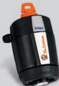
DOL 53 est un capteur permettant de mesurer en permanence la concentration d'ammoniac dans l'air du bâtiment. Il est robuste et fournit une mesure très précise dans une plage comprise entre 0 et 100 ppm de NH 3 .
