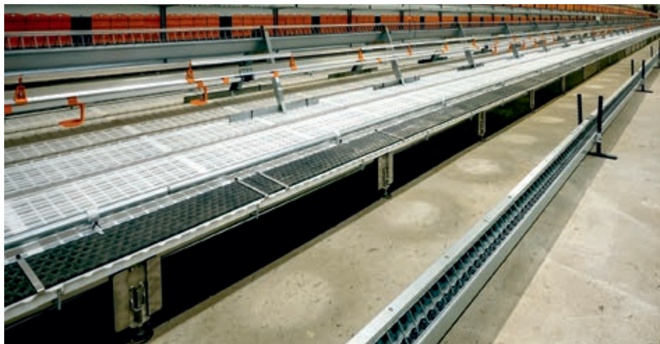
System do usuwania pomiotu z nawijaną taśmą umieszczoną pod rusztem z wysokością naskoku tylko 280 mm
