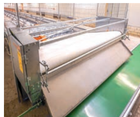
Pomiot jest przekazywany na umieszczony w kanale przenośnik poprzeczny
