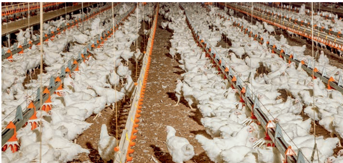
ReproMatic z FluxxBreeder – kombinacja karmideł i przenośnika łańcuchowego, która również zapewnia szybkie i równomierne rozprowadzenie paszy
