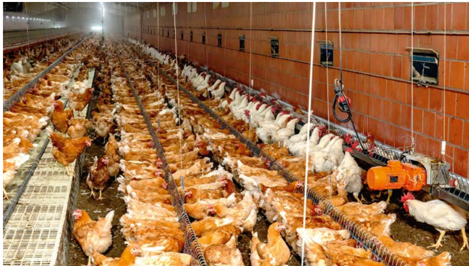
Hală pentru păsări de reproducție din rase grele, cu hrănire separată a masculilor, cu MaleChain
