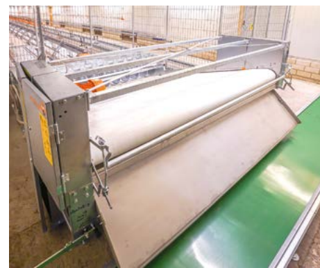
Dejecțiile sunt transferate pe o bandă intersectată la nivelul podelei
