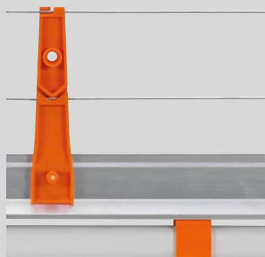
Ніпельна труба з алюмінієвим профілем і подвійним дротом проти сидання птиці
