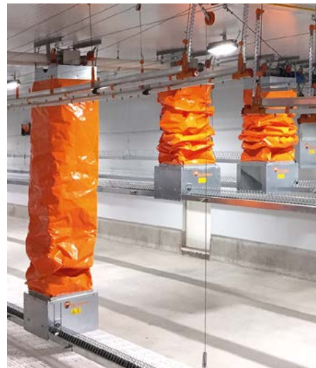
Рукав подачі корму: компактний і зручний
